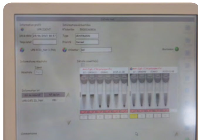
Résultats à l'écran d'une RAI sur 11 hématies : si le liquide test tombe au fond, le résultat est négatif pour cet anticorps, s'il s'agglutine sur les parois, le test est positif
